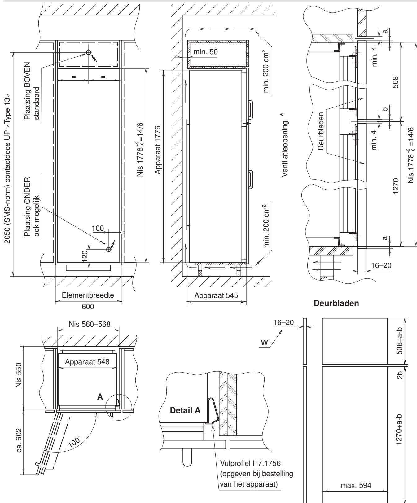
\* Voor een optimale ventilatie is een opening – boven en onder – binnen de breedte van het apparaat noodzakelijk (blad 5–13 in het Technisch Keukenhandboek van de KVS, Keukenbond Zwitserland).
