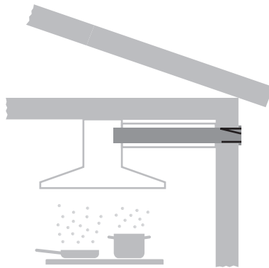
Mit seitlich sichtbarem Abluftkanal
