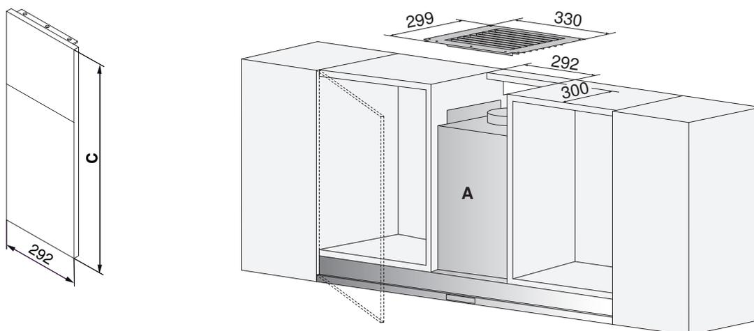
Per poter sostituire il filtro, la copertura anteriore **A** deve essere smontabile.
