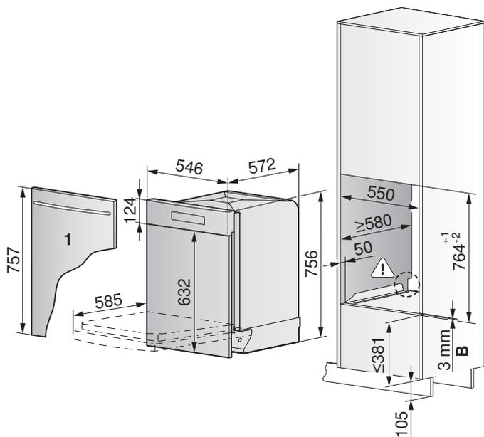
Installazione in alto «vano ampio»
