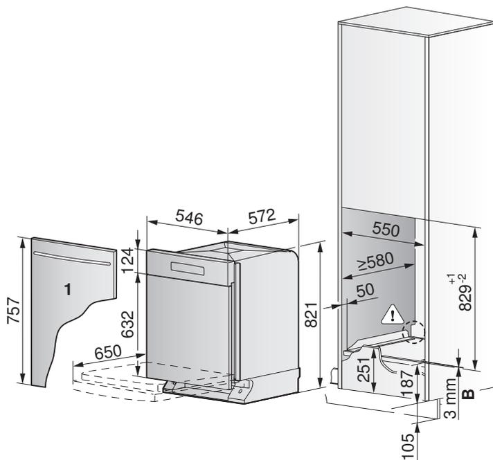
Sezione trasversale variante d'installazione
