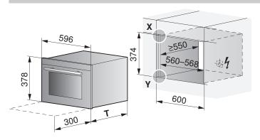
Gerät Miwell-Combi HSL Miwell HSL **T** 516 mm 470 mm
