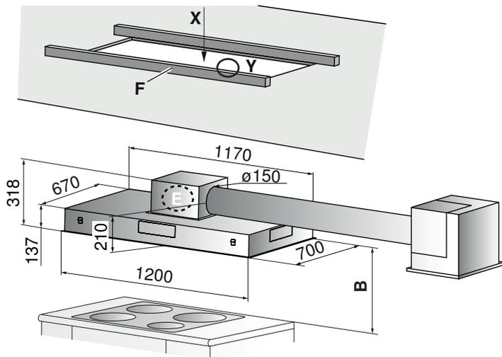
Motorengehäuse **E** auf alle vier Seiten drehbar
