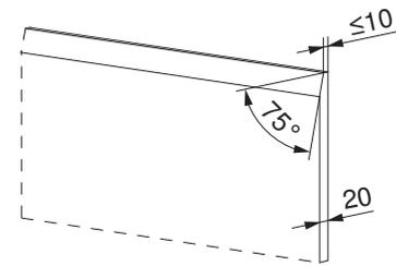
\* Bei einem Einbau des Dunstabzuges auf dem Niveau der Schrankunterseite, müssen auf Grund der oberen Abzugsabdeckung zusätzlich 2 mm eingeplant werden.
