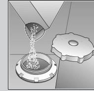
Max. 1,5 kg Spezzialsalz (nie Reiniger!) einfüllen.
