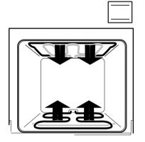
Ober-/Unterhitze ist die konventionelle Heizart. Die Beheizung erfolgt mit den Heizkörpern oben und unten im Garraum. Das Backen und Braten ist nur auf einer Auflage möglich. Je nach verwendeter Auflage wird die Ober- bzw. die Unterhitze mehr oder weniger wirksam.
