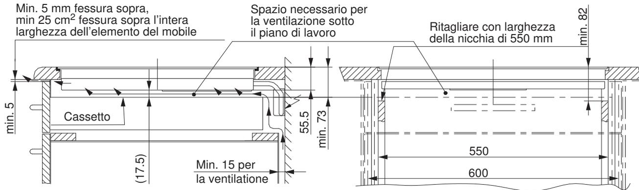
**Montaggio della lamiera di protezione per la ventilazione con fessura di aerazione di 3 mm sulla parte anteriore (vedi 'Accessori')**
