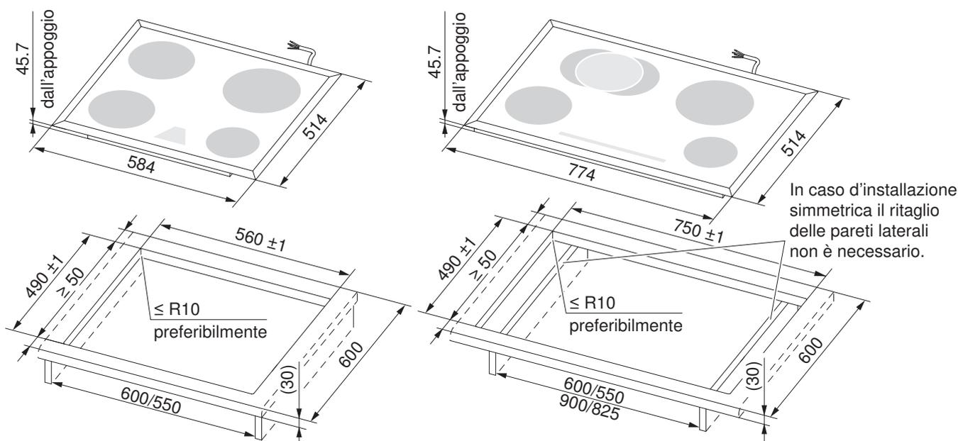
1. Eseguire con precisione l'intaglio di montaggio.
