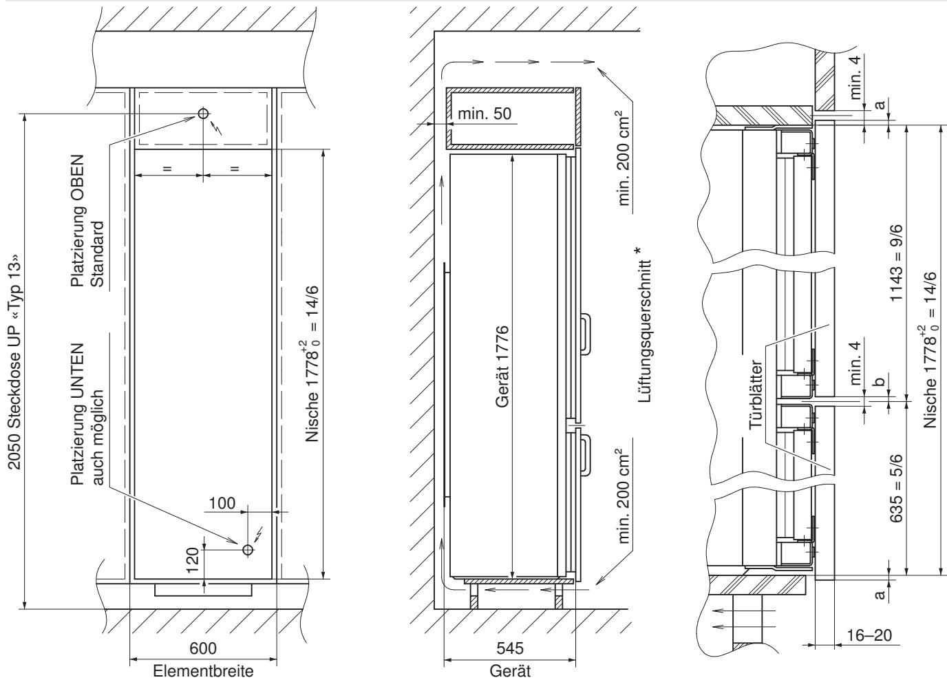
\* Für eine einwandfreie Belüftung ist eine Öffnung – oben und unten – innerhalb der Gerätebreite notwendig (Blatt 5–13 im Technischen Küchenhandbuch KVS).
