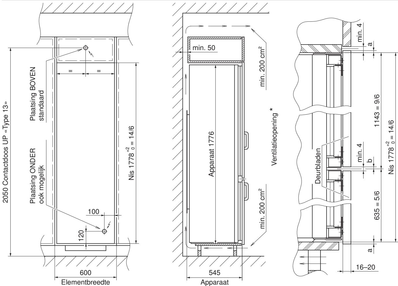
\* Voor een optimale ventilatie is een opening – boven en onder – binnen de breedte van het apparaat noodzakelijk (blad 5–13 in het Technisch Keukenhandboek van de KVS, Keukenbond Zwitserland).
