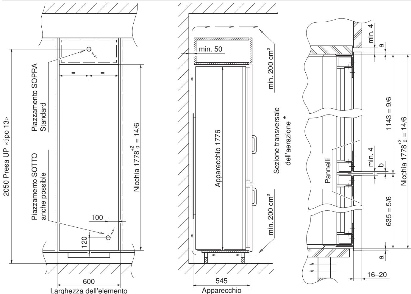
\* Per assicurare una ventilazione ineccepibile, è necessaria un'apertura – sopra e sotto – all'interno della larghezza dell'apparecchio (foglio 5–13 nel manuale tecnico per le cucine «Technisches Küchenhandbuch KVS»).
