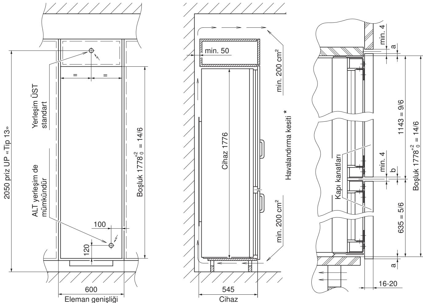
\* Kusursuz bir havalandırma için cihaz genişliği içinde üstte ve alta bir aralık olması gereklidir (Teknik mutfak el kitabındaki KVS 5.-13. sayfa). Birçok elemen üzerinden geçseler de gölgé fugaları yeterli değildir.
