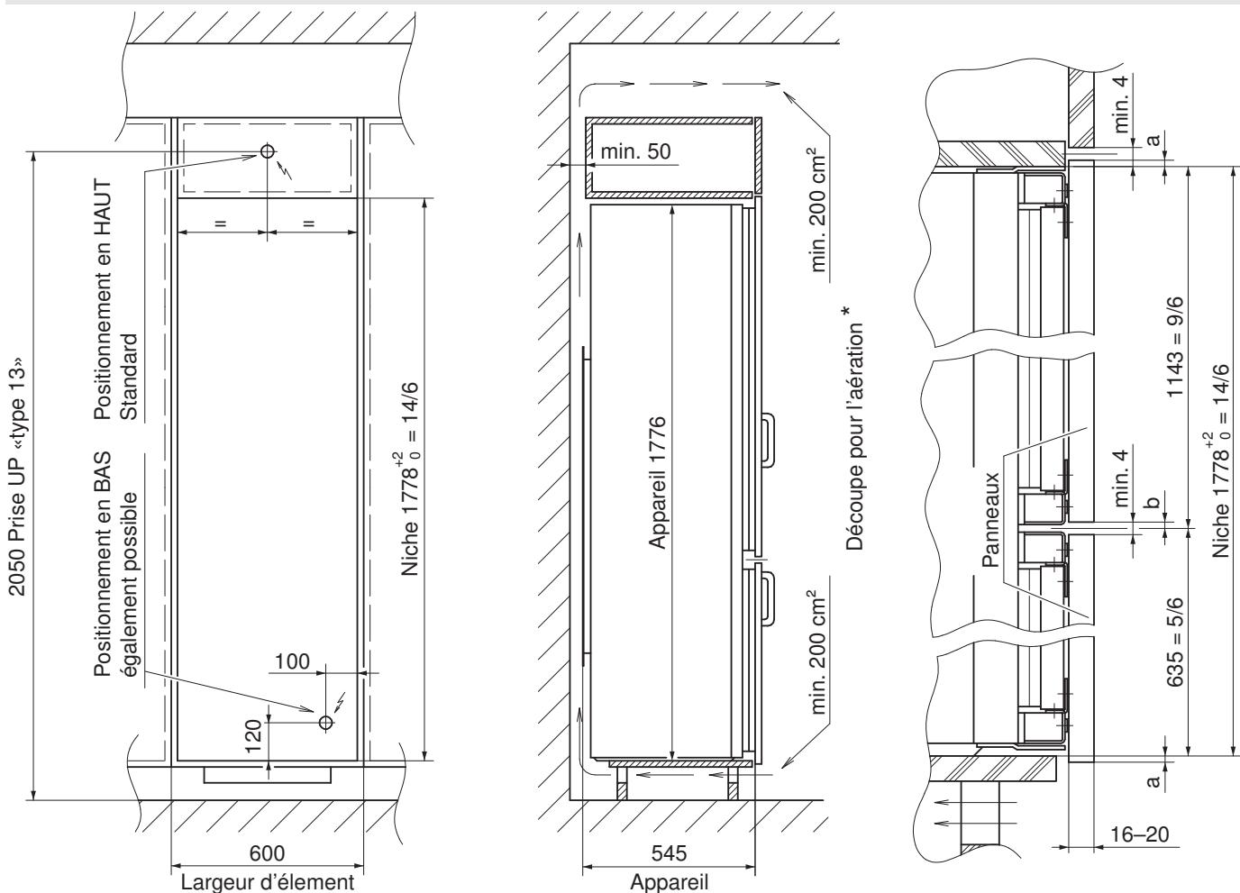
\* Pour une aération parfaite, une ouverture – en haut et en bas – de la largeur de l'appareil est nécessaire (feuille 5–13 dans le manuel technique pour les cuisines ASC).
