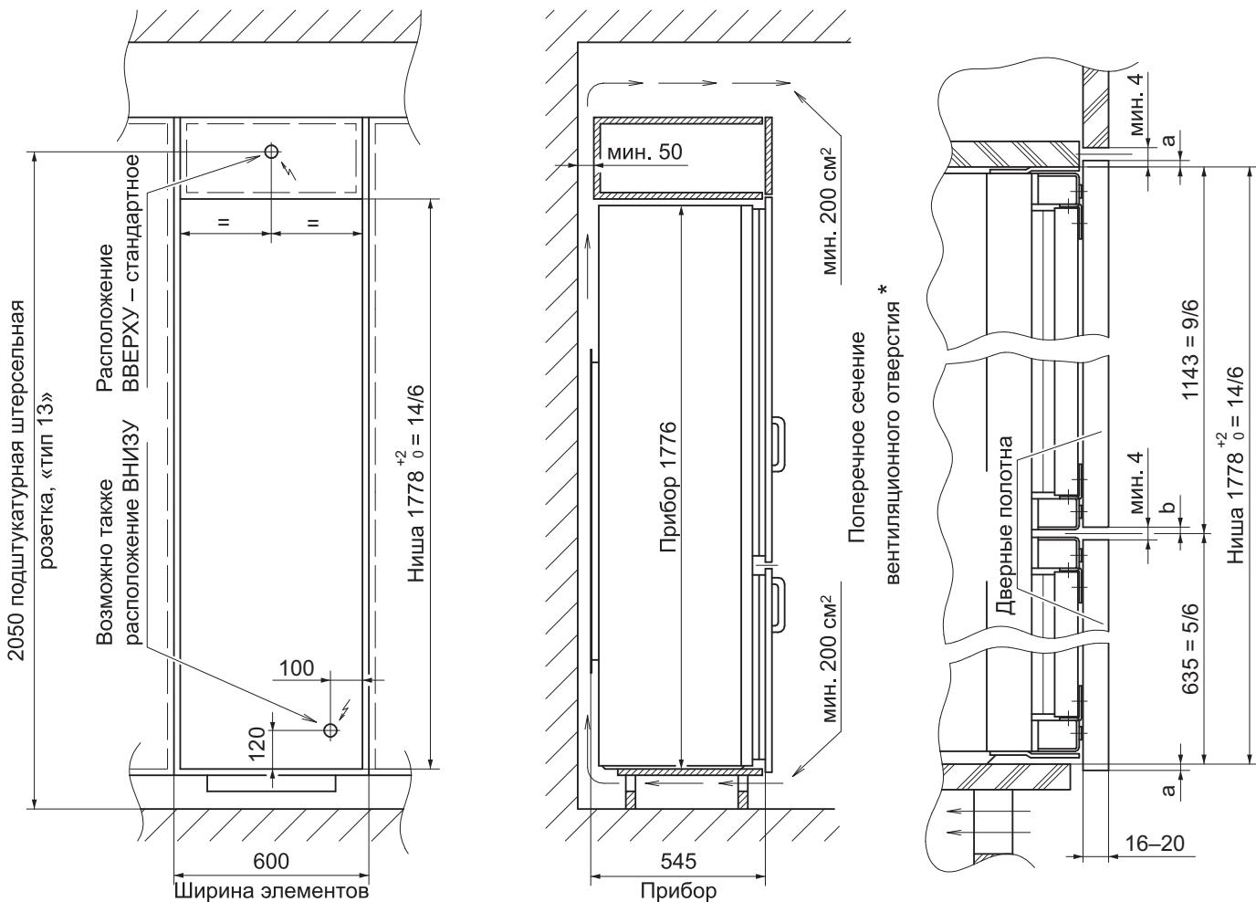
\* Для бесперебойной вентиляции требуется отверстие – вверху и внизу – в пределах ширины прибора (лист 5–13 в Технических нормах для кухонь KVS).
