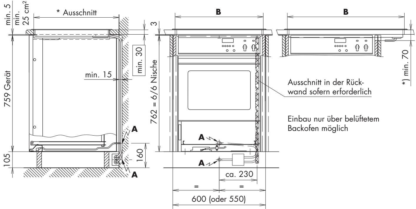
**Einbau-Backöfen mit Verwendung von Lüftungsgitter (siehe auch J402.54)**
