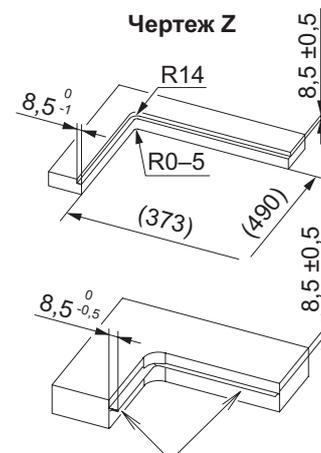
Стальные уголки, приклеенные или привинченные (клей см. «Принадлежности»)
