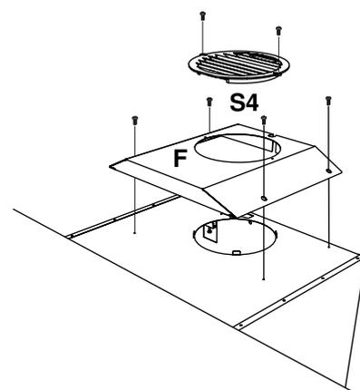
9. Haube einhängen und mittels Schrauben **12A** (4×45 mm) festziehen.
