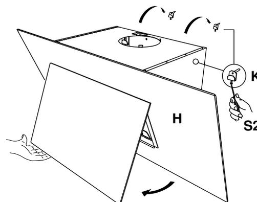
7. Haube **H** aushängen und Löcher  $\varnothing 8$  mm für zwei Schrauben **12A** (4×45 mm) bohren.
