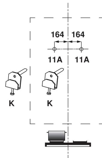
4. Montagewinkel **K** mit Schrauben **11A** (M5×50 mm) montieren und Haube **H** einhängen.
