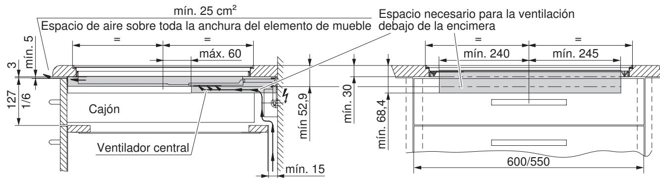
**Con chapa protectora debajo del ventilador**
