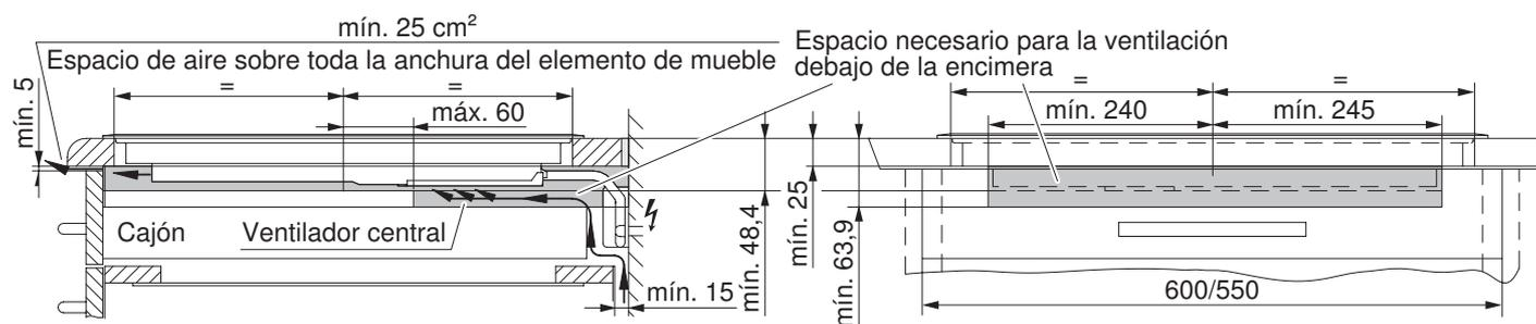
**Con chapa protectora debajo del ventilador**
