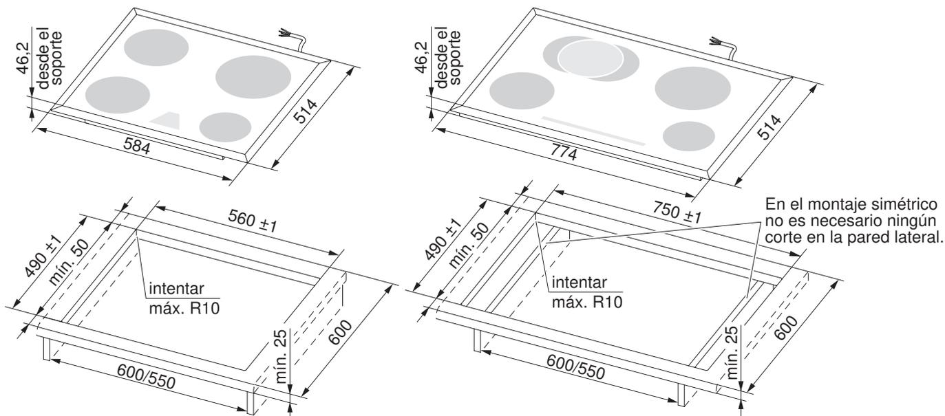
1. El corte de montaje debe realizarse de forma precisa.
