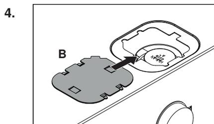
4. ▶ Faire glisser le couvercle du filtre à air **B** sur l'ouverture du filtre à air.
