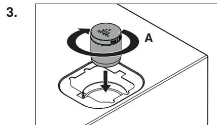
3. ▶ Visser le filtre à air **A** dans l'ouverture du filtre à air à l'aide d'un tournevis.
