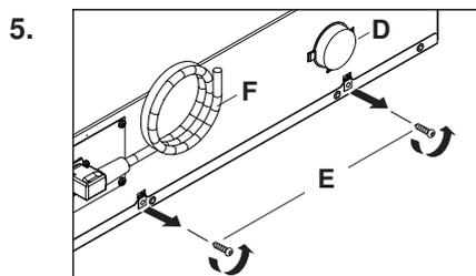
5. ▶ Dévisser les fixations de transport **E** sous le câble de raccordement **F** et le support **D**.
