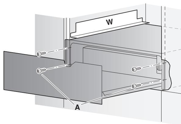
1. Fixer le set d'équerres 55 ou 60 (non fourni) pour un appareil placé au-dessus ou au-dessous.
