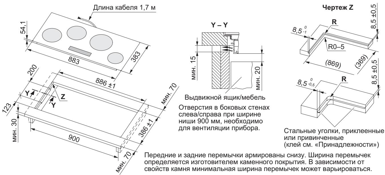
Передние и задние перемычки армированы снизу. Ширина перемычек определяется изготовителем каменного покрытия. В зависимости от свойств камня минимальная ширина перемычек может варьироваться.
