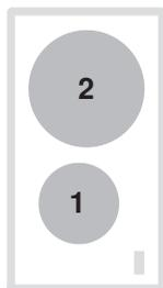
不可同时在两个炉盘上使用 PowerPlus。如果同时激活了两个炉盘的 PowerPlus，则首先设定的炉盘的功率将降低。显示中将交替出现旋转开关所调到的功率等级和新降低到的功率等级。
