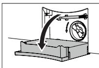
► Faire basculer le récipient d'écoulement complètement vers le bas. Procéder si nécessaire à une vidange d'urgence.
