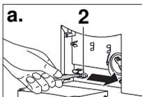
► Placer le dispositif d'ouverture dans le capot d'ouverture bleu **2** et tirer dans le sens de la flèche.
