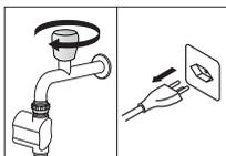
► Fermer le robinet d'eau et débrancher l'appareil du secteur.
