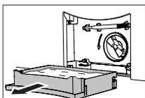
► Vider le récipient d'écoulement, le remettre en place et le pousser horizontalement jusqu'en butée.
