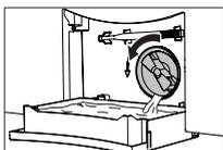
► Desserrer légèrement le piège à corps étrangers en le tournant avec précaution vers la gauche afin que l'eau s'écoule peu à peu.
