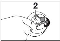
► À l'aide du dispositif d'ouverture du déverrouillage d'urgence **2**, vérifier que le rouet de la pompe de vidange tourne.
