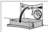
► Faire basculer le récipient d'écoulement complètement vers le bas. Il sert en même temps de bac récepteur pour l'eau qui s'écoule.
