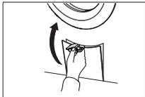
► Ouvrir le récipient d'écoulement à l'aide du clapet pour lessive liquide.
