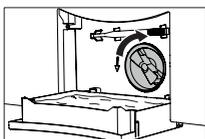
► Fermer le piège à corps étrangers en le tournant vers la droite et tirer le récipient d'écoulement vers l'avant.
