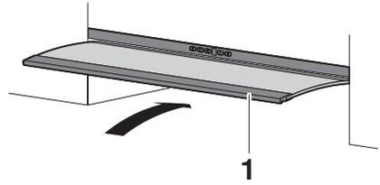
Wird der Glasschirm wieder etwas herausgezogen, schaltet sich das Absauggebläse auf der eingestellten Stufe ein bzw. die Beleuchtung geht an, sofern diese beim Einschieben des Glasschirmes eingeschaltet war.
