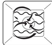
Beim Kombibetrieb wird zusätzlich mit Mikrowellen gegart, wodurch sich die Gardauer verkürzt.
