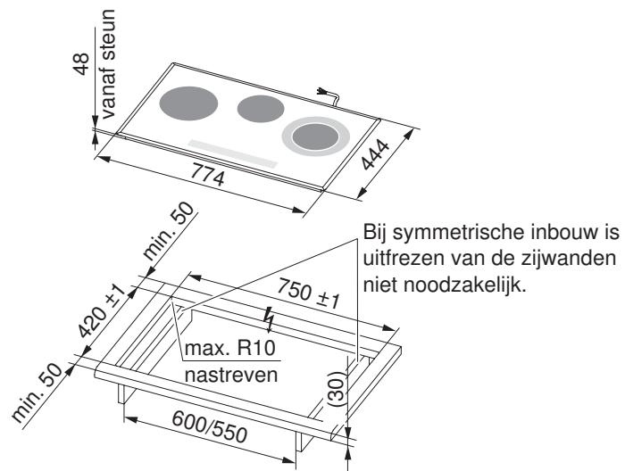
1. Inbouwuitsparing nauwkeurig aanbrengen.
