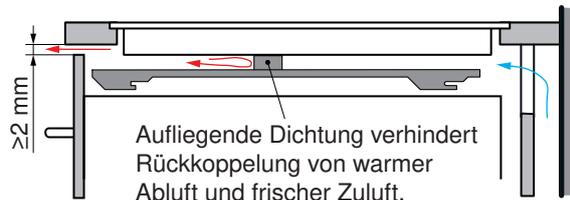
Lüftungsschutzbleche erzielen nur mit der aufliegenden Dichtung den gewünschten Effekt. Daher können die Schaumstoff Dichtungen auch einzeln bezogen werden, um Bleche anderer Fabrikate nachzurüsten (siehe Seite 222).
