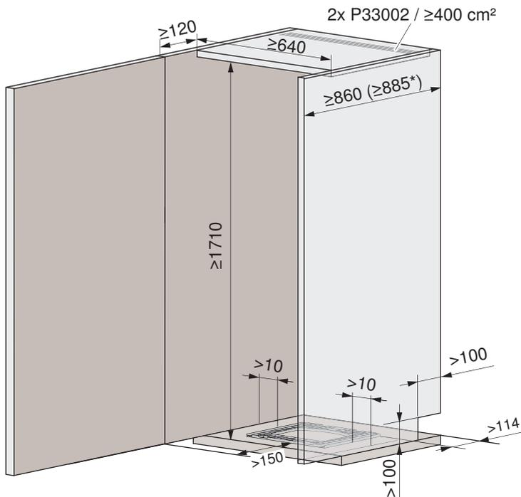
\* Bei CombiAdoraTrocknen V4000: Empfohlene Nischentiefe, welche bei zukünftigen Modellen zwingend wird.
