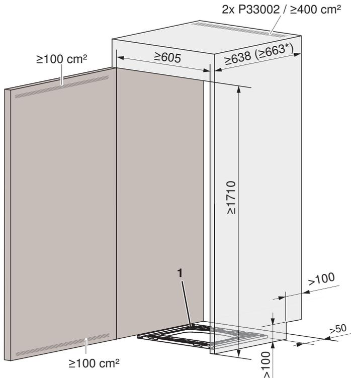
\* Bei CombiAdoraTrocknen V4000: Empfohlene Nischentiefe, welche bei zukünftigen Modellen zwingend wird.
