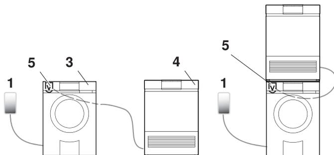
Die Wäschetrockner der Excellence Line lassen sich mit dem Kombiablaufset W55969 (5) als Zubehör nachrüsten. Dies ermöglicht den Wasserablauf eines Waschautomaten und eines Wäschetrockners an einen einzigen Wasserablauf (Unterputz-Siphon 1) anzuschliessen. Das Wasser des Wäschetrockners wird mit der Pumpe in den Wasserablauf des Waschautomaten gepumpt.
