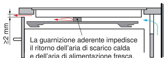
Le lamiere di protezione per la ventilazione ottengono l'effetto desiderato solo con la guarnizione applicata. Pertanto le guarnizioni in espanso possono essere acquistate anche singolarmente da applicare su lamiere di altre marche (vedi pagina 148).
