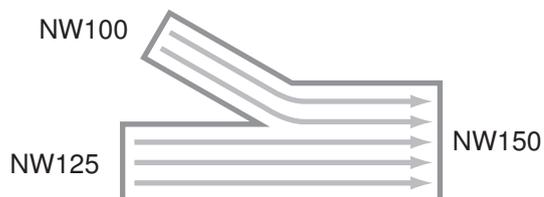
In un raccordo a Y vengono collegati due canali. L'angolo di collegamento non deve essere verticale onde evitare la formazione di vortici e l'aumento della resistenza aerodinamica. I due canali devono sfociare possibilmente in un angolo appuntito, in modo da ridurre la resistenza al minimo.
