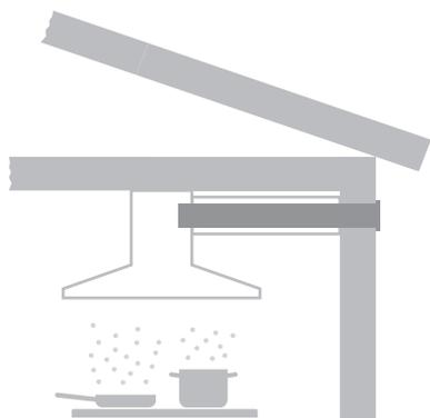
Conduttura dell'aria di scarico con pendenza minima dell'1% verso l'esterno.
