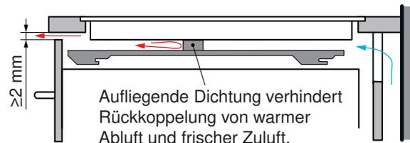
Lüftungsschutzbleche erzielen nur mit der aufliegenden Dichtung den gewünschten Effekt. Daher können die Schaumstoff Dichtungen auch einzeln bezogen werden, um Bleche anderer Fabrikate nachzurüsten (siehe Seite 219).
