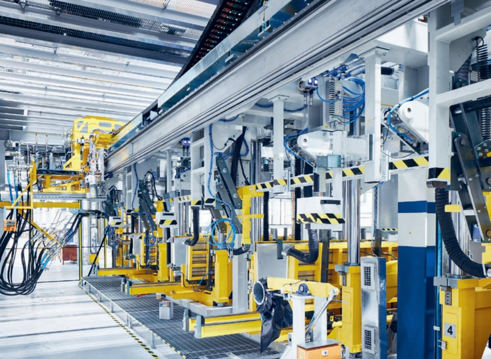
Behälterschäumenanlage zur Isolation und Verstärkung der Kühlschränke
