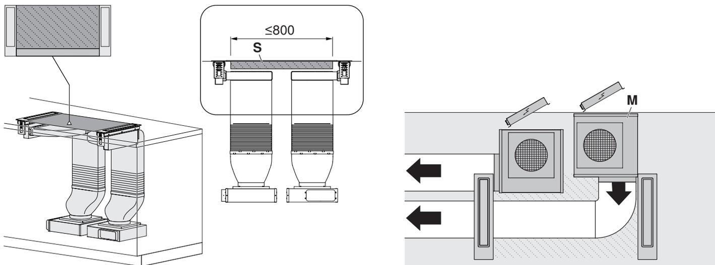
**Variante d'installazione aspiratore per piano cottura con circolazione dell'aria «box di circolazione dell'aria».**
