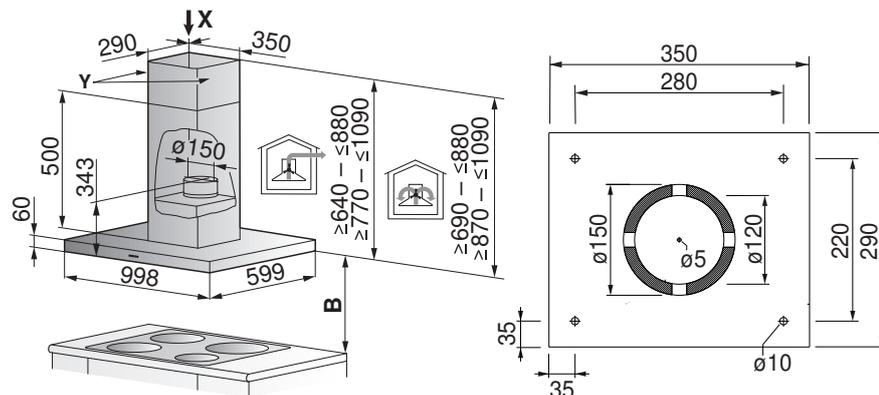
**Uscita dell'aria con circolazione dell'aria (dettaglio Y)**
