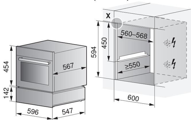
**Installazione con forno e forno compatto o vaporiera**
