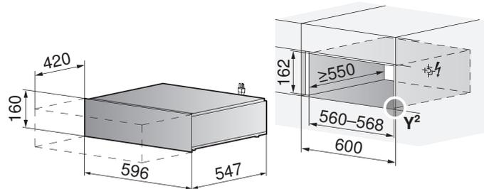
**Installazione con forno e miniforno o vaporiera**
