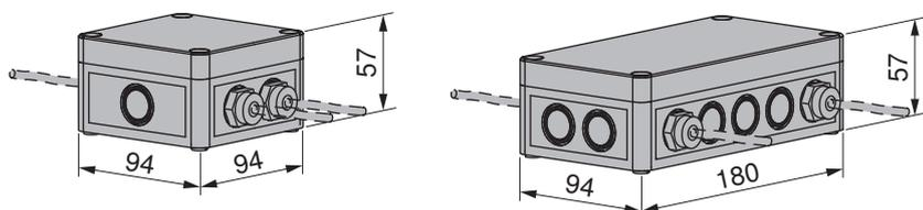
Il set di comando opzioni serve per controllare apparecchi esterni (ad es. ventilatore) mediante un segnale di comando generato da un apparecchio V-ZUG. Per un funzionamento efficace, occorre conoscere le caratteristiche elettriche di entrambi i dispositivi. Un chiarimento accurato è indispensabile e presuppone competenze elettrotecniche. Per queste ragioni, la progettazione e l'installazione devono essere effettuate esclusivamente da personale elettrotecnico specializzato.
