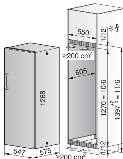
Per il collegamento della spina di rete deve essere possibile rimuovere la parete posteriore dell'armadio.
