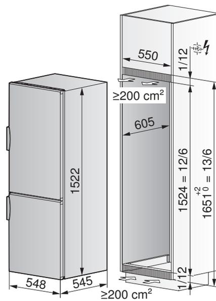
Per il collegamento della spina di rete deve essere possibile rimuovere la parete posteriore dell'armadio.
