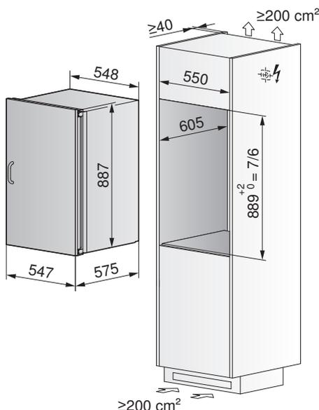
**Variante d'installazione con griglia di ventilazione**
