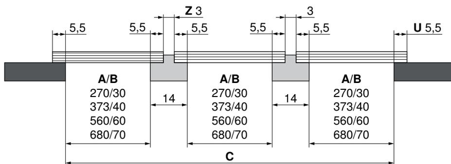
Esempio per larghezza della sezione C con 30+30+30 cm:  $270+14+270+14+270 = 838$  mm
