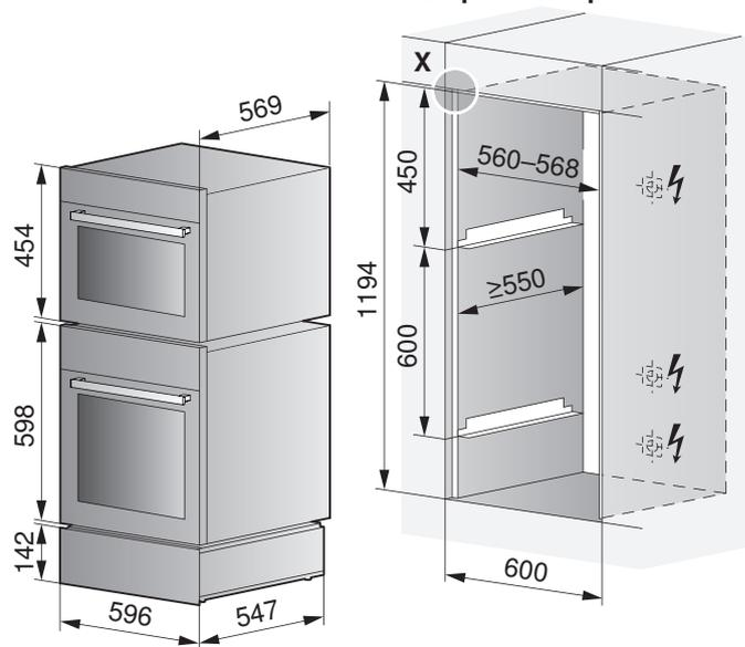
**Installazione con forno compatto o vaporiera**
