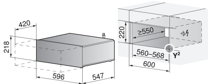
**Installazione con miniforno o vaporiera**
