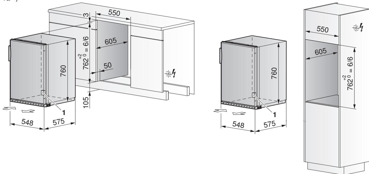
1 ventilatore per aerazione (vedere anche KPV)
