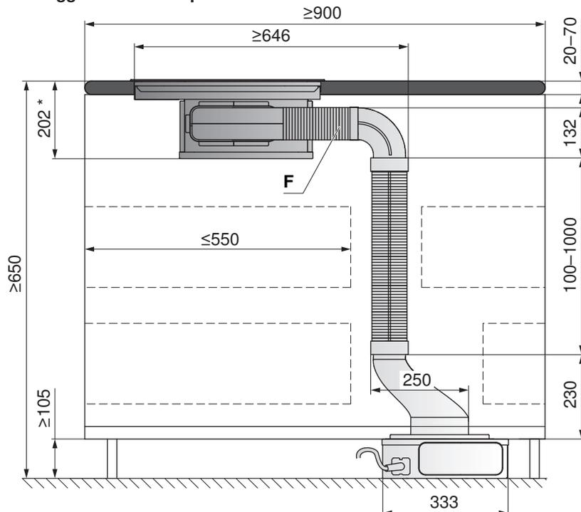
\* Installazione in appoggio (installazione a filo 206 mm)
