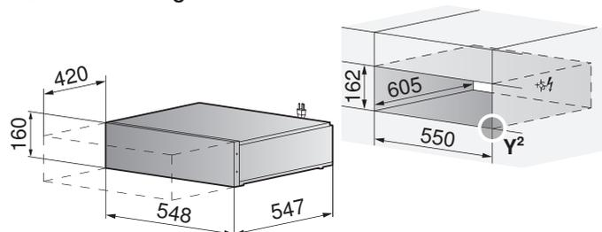
**Installazione con forno e miniforno o vaporeiera**
