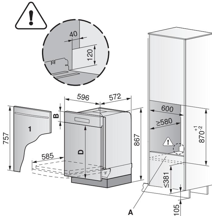
Sezione esempio d'installazione
