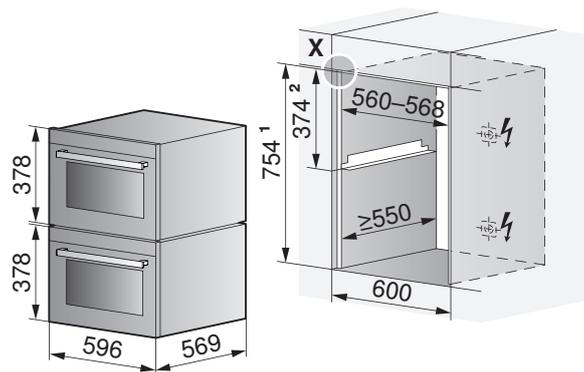
Installazione SMS: <sup>1</sup> altezza nicchia 762 mm/<sup>2</sup> altezza 381 mm
