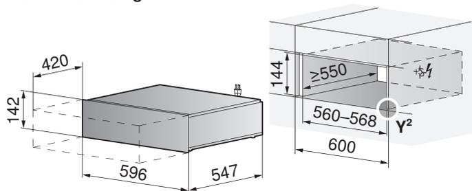
**Installazione con forno e forno compatto o vaporiera**
