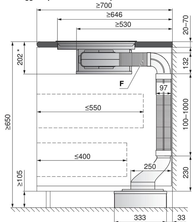
**Montaggio a isola con profondità  $\geq 900$  mm**
