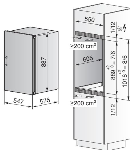
Per il collegamento della spina di rete deve essere possibile rimuovere la parete posteriore dell'armadio.
