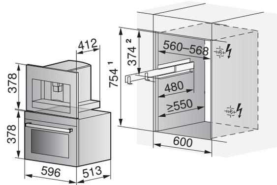
Installazione SMS: <sup>1</sup> altezza nicchia 762 mm/<sup>2</sup> altezza 381 mm
