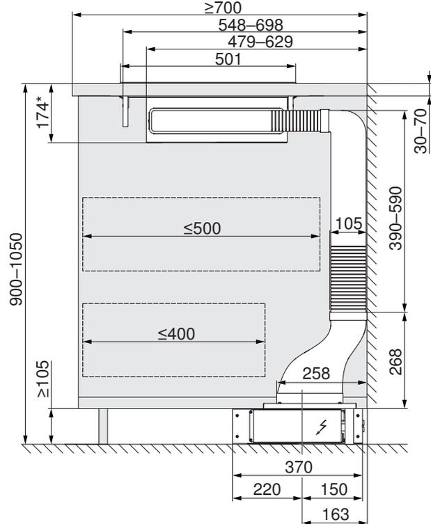
Montaggio a isola, profondità  $\geq 900$  mm
