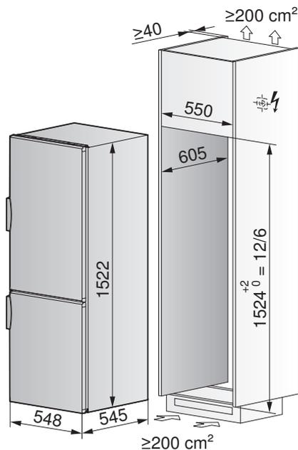
**Variante d'installazione con griglia di ventilazione**
