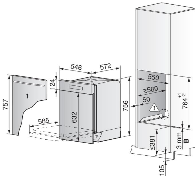
Installazione in alto «vano ampio»
