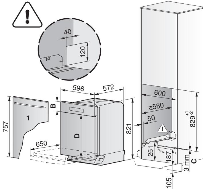
Sezione trasversale variante d'installazione
