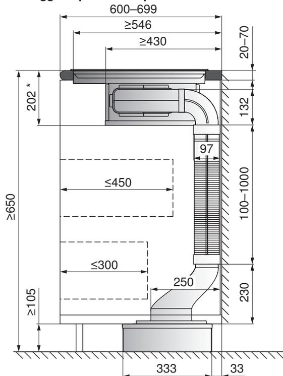
**Montaggio a parete/a isola con profondità  $\geq 700$  mm**
