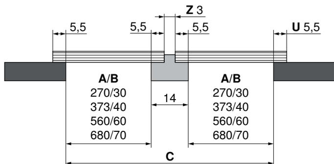
Esempio per larghezza della sezione C con 30+30 cm:  $270+14+270 = 554$  mm
