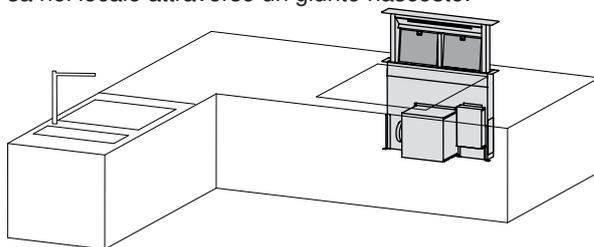
Sezione dell'apertura per l'aria di scarico: prevedere almeno 500 cm<sup>2</sup> per l'aria di scarico nell'area dello zoccolo.
