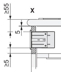
X = fessura di ventilazione di 5 mm per l'intera larghezza dell'elemento, min. 25 cm<sup>2</sup>.
