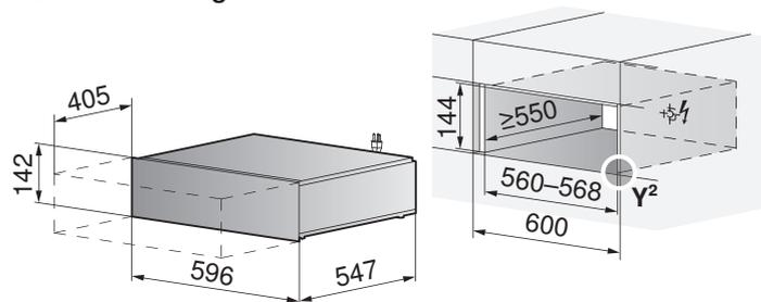
**Installazione con forno compatto o vaporiera**
