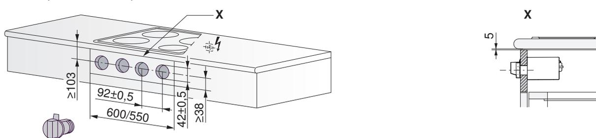
X = fessura di ventilazione di 5 mm per l'intera larghezza dell'elemento, min. 25 mm<sup>2</sup>.
