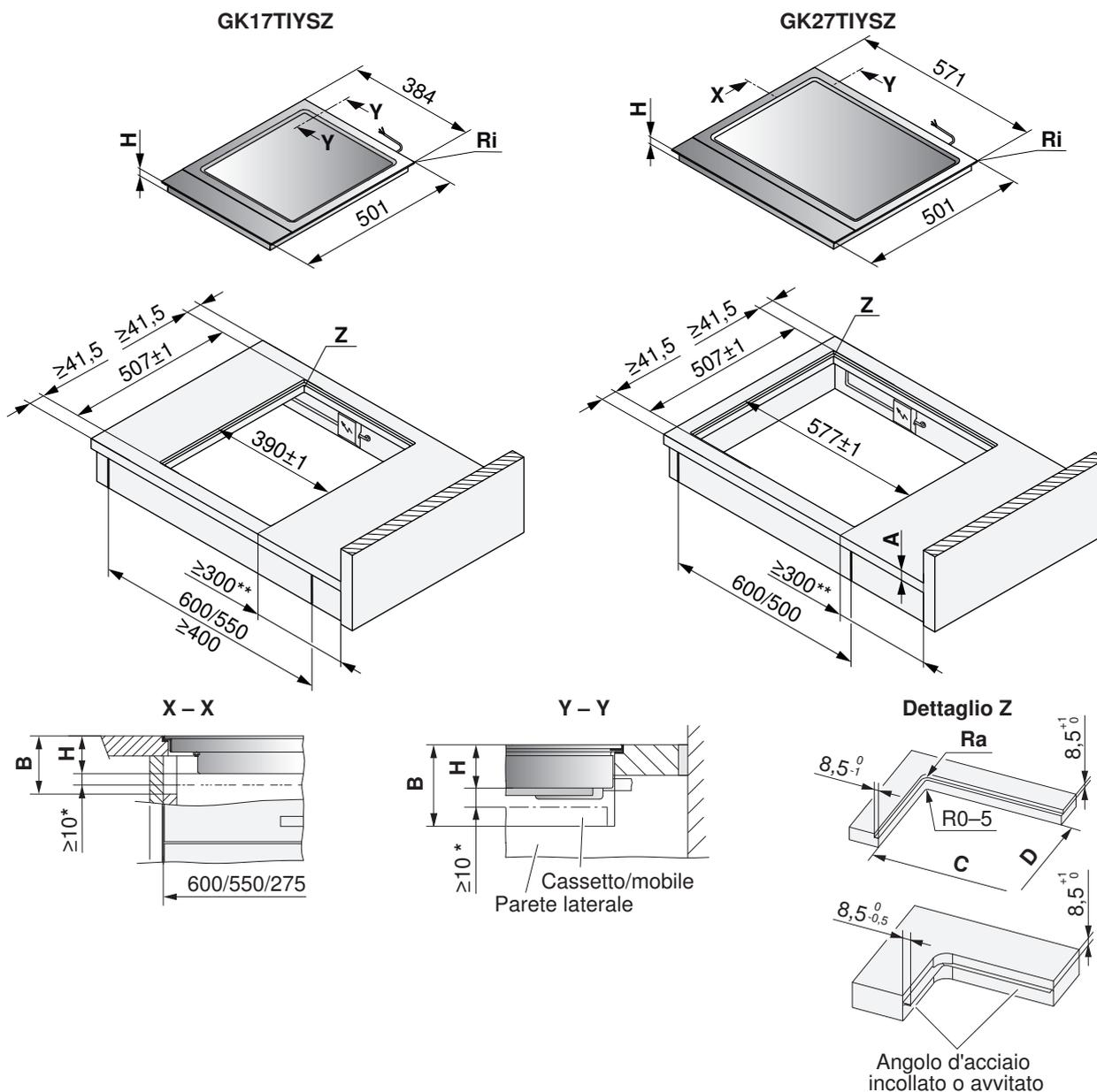
\* Garantire assolutamente la presenza di spazio libero (per la ventilazione)!
