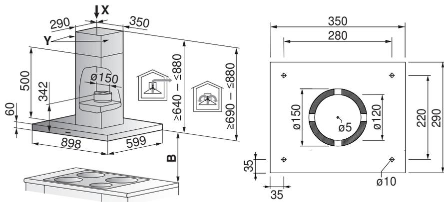
Uscita dell'aria con circolazione dell'aria (dettaglio Y)
