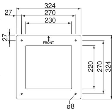
Uscita dell'aria con circolazione dell'aria (dettaglio Y)
