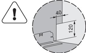
Installazione in alto «vano ampio» con decorazione 5/6 e cassetto 2/6
