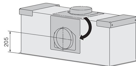
La cappa aspirante può essere modificata in modo tale da permettere al bocchettone dell'aria di scarico di trovarsi sul lato posteriore dell'apparecchio.
