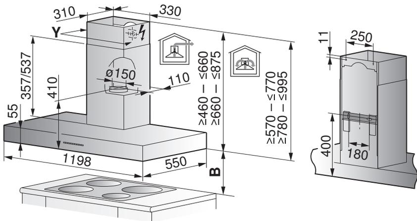
**Uscita dell'aria con circolazione dell'aria (dettaglio Y)**
