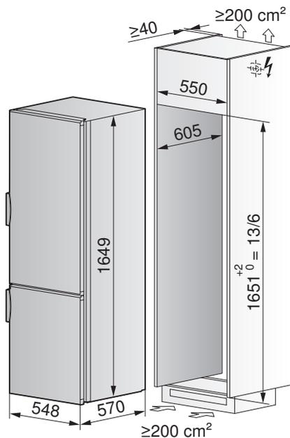
**Variante d'installazione con griglia di ventilazione**
