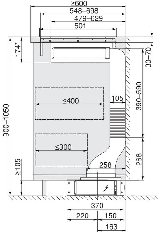
Montaggio a parete/a isola, profondità  $\geq 700$  mm
