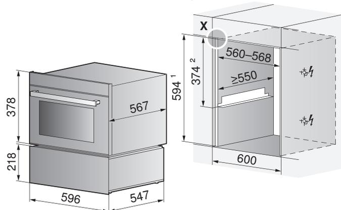
Altezza d'installazione SMS: <sup>1</sup> altezza nicchia 600 mm/<sup>2</sup> altezza 381 mm
