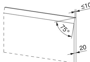
Variante di installazione: parzialmente visibile (TS), visibile (SI)
