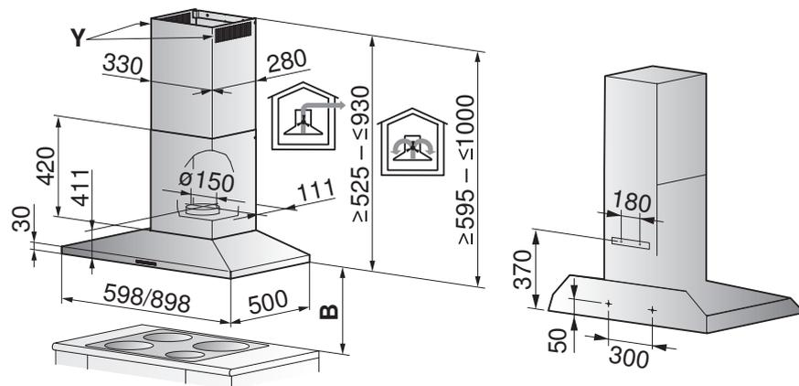
**Uscita dell'aria con circolazione dell'aria (dettaglio Y)**
