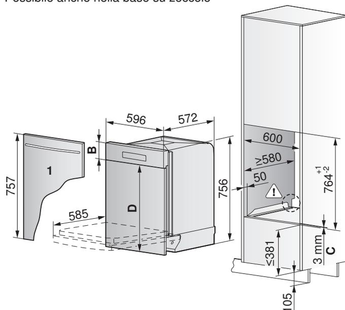
**Installazione in alto «vano ampio»**
