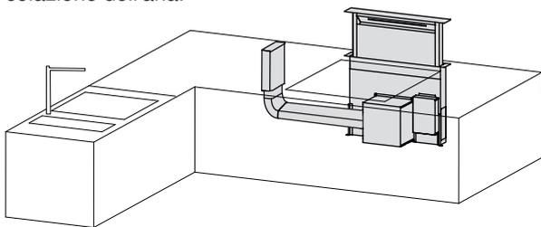
Sezione dell'apertura per l'aria di scarico: prevedere almeno 500 cm<sup>2</sup> per l'aria di scarico nell'area dello zoccolo.
