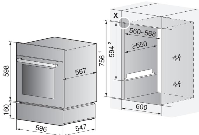
Altezza d'installazione SMS: <sup>1</sup> altezza nicchia 762 mm/<sup>2</sup> altezza 600 mm
