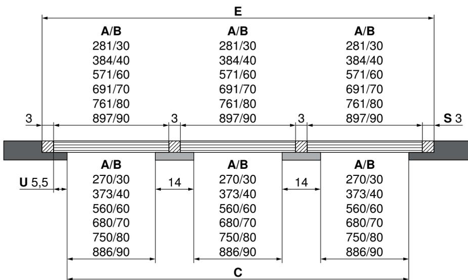
Esempio per larghezza della sezione **E** con 30+30+30 cm:  $3+281+3+281+3+281+3 = 855$  mm
