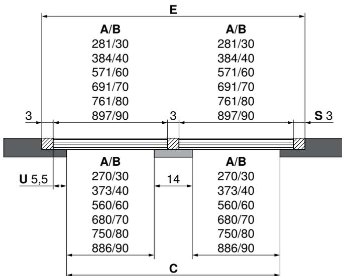
Esempio per larghezza della sezione **E** con 30+30 cm:  $3+281+3+281+3 = 571$  mm
