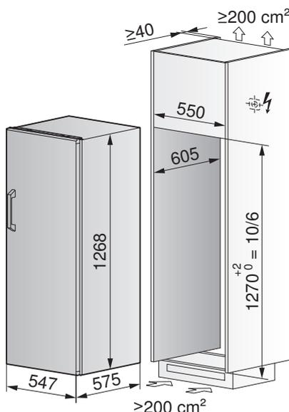
**Variante d'installazione con griglia di ventilazione**
