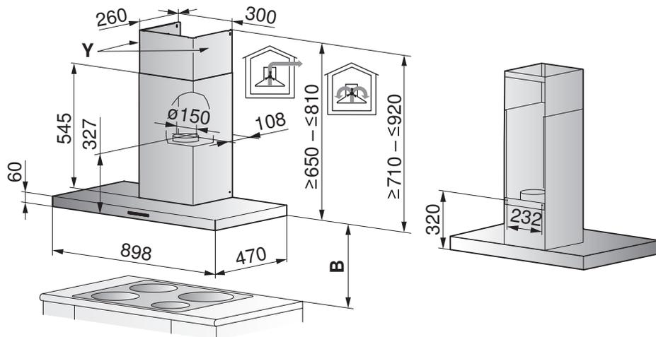
**Uscita dell'aria con circolazione dell'aria (dettaglio Y)**
