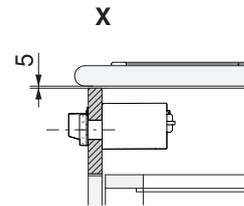
X = Lüftungsschlitze 5 mm über die gesamte Elementbreite, min. 25 mm<sup>2</sup>.
