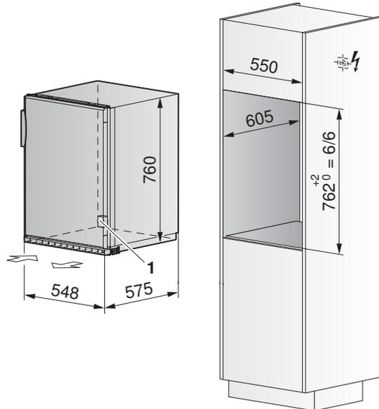
1 Lüftungsventilator, 2 Befestigungswinkel bei Steinabdeckung (nicht im Lieferumfang enthalten).
