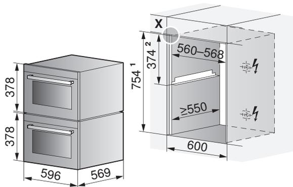
Einbau SMS: <sup>1</sup> Nischenhöhe 762 mm/<sup>2</sup> Höhe 381 mm
