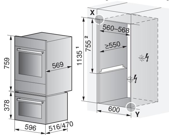
Einbau SMS: <sup>1</sup> Nischenhöhe 1143 mm/<sup>2</sup> Höhe 762 mm
