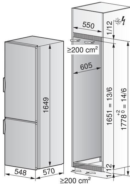
Für Netzsteckeranschluss muss Rückwand am Schrank entfernt werden können.
