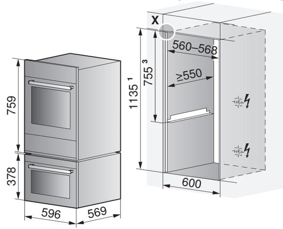
Einbau SMS: <sup>1</sup> Nischenhöhe 1143 mm/<sup>3</sup> Höhe 762 mm
