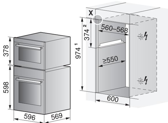
Einbau SMS: <sup>1</sup> Nischenhöhe 981 mm, bei Nischenhöhe 1016 mm: Ausgleichselemente, siehe Kapitel Zubehör (siehe Seite 225)/<sup>2</sup> Höhe 381 mm
