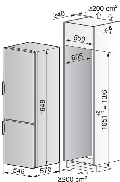
**Einbauvariante mit Lüftungsgitter**
