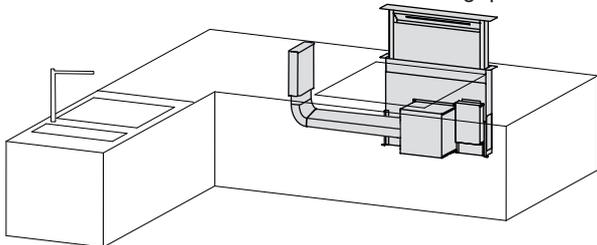
Abluftöffnungsquerschnitt: min. 500 cm<sup>2</sup> für die Abluft im Sockelbereich vorsehen.
