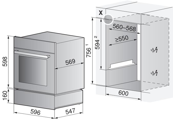
Einbauhöhe SMS: <sup>1</sup> Nischenhöhe 762 mm/<sup>2</sup> Höhe 600 mm
