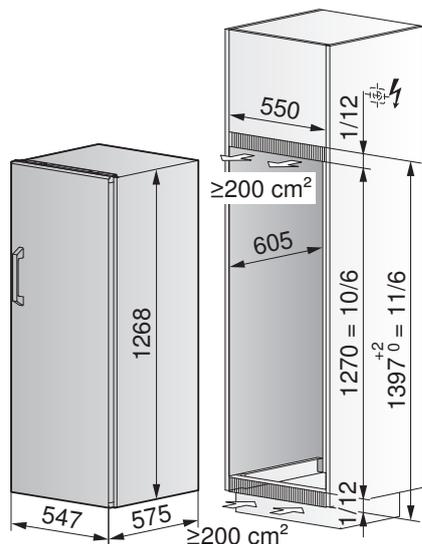
Für Netzsteckeranschluss muss Rückwand am Schrank entfernt werden können.
