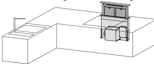
Abluftöffnungsquerschnitt: min. 500 cm<sup>2</sup> für die Abluft im Sockelbereich vorsehen.
