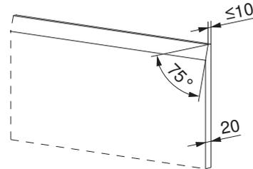
Einbauvariante: Teilsichtbar (TS), Sichtbar (SI)
