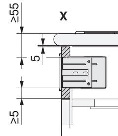
X = Lüftungsschlit 5 mm über die gesamte Elementbreite, min. 25 cm<sup>2</sup>.
