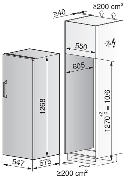
**Einbauvariante mit Lüftungsgitter**
