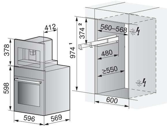
Einbau SMS: <sup>1</sup> Nischenhöhe 981 mm/<sup>2</sup> Höhe 381 mm
