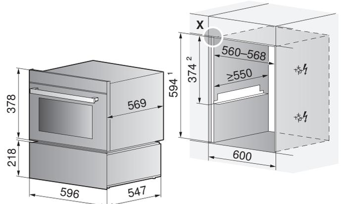
Einbauhöhe SMS: <sup>1</sup> Nischenhöhe 600 mm/<sup>2</sup> Höhe 381 mm
