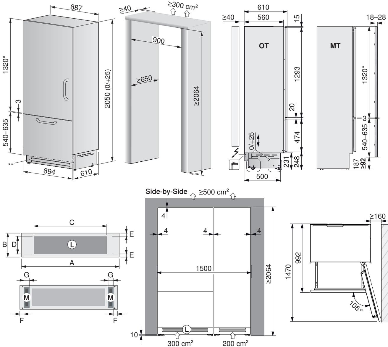
\* = Bei Nischenhöhe >2064 muss Türdoppelhöhe angepasst werden.
