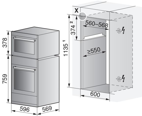
Einbau SMS: <sup>1</sup> Nischenhöhe 1143 mm/<sup>2</sup> Höhe 381 mm
