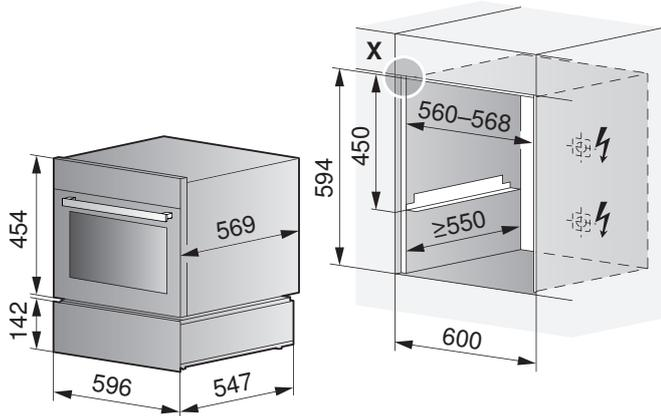
Einbau mit Backofen & Kompaktbackofen oder Steamer
