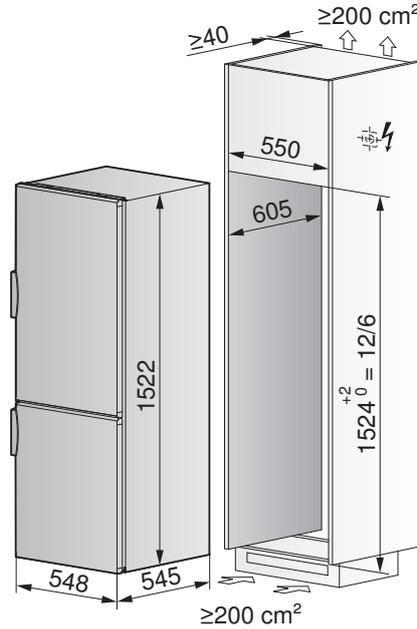
**Einbauvariante mit Lüftungsgitter**
