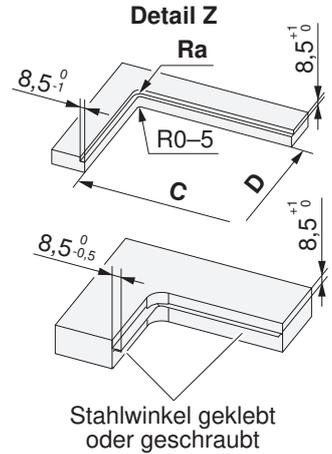
Stahlwinkel geklebt oder geschraubt
