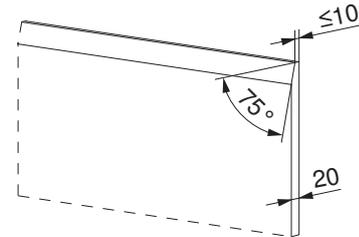
Einbauvariante: Teilsichtbar (TS), Sichtbar (SI)
