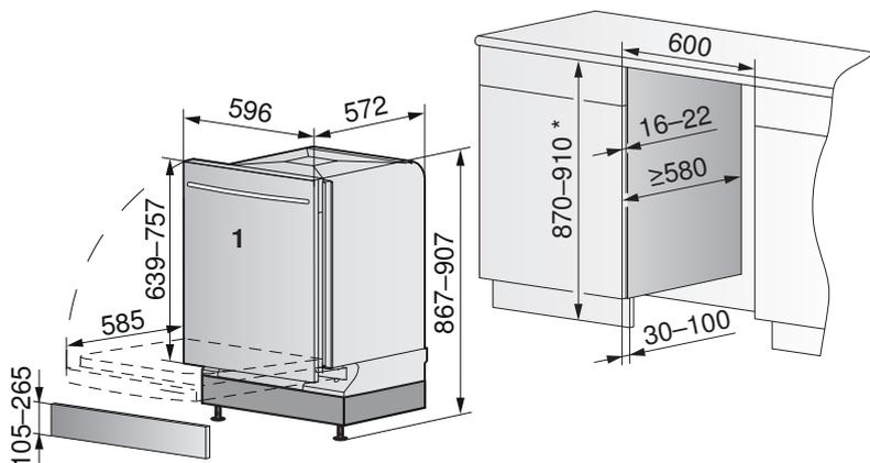
\* Bei einer Nischenhöhe von mehr als 910 mm muss eine Platte unterlegt oder ein überlanges Dekor eingesetzt werden.
