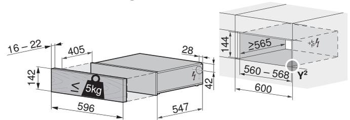
Einbau mit Kompaktbackofen oder Steamer
