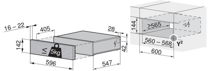
Einbau mit Kompaktbackofen oder Steamer
