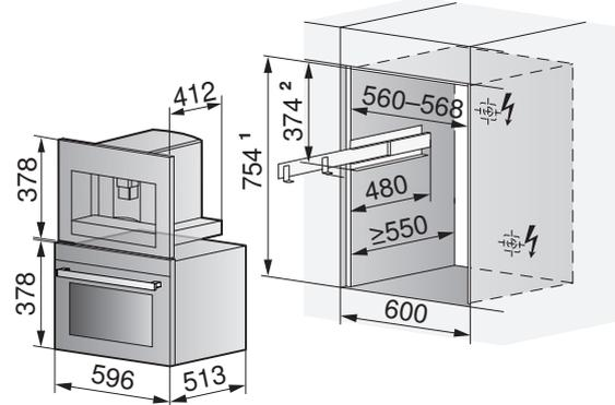
Einbau SMS: <sup>1</sup> Nischenhöhe 762 mm/<sup>2</sup> Höhe 381 mm
