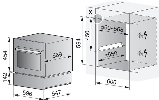
Einbau mit Backofen & Kompaktbackofen oder Steamer
