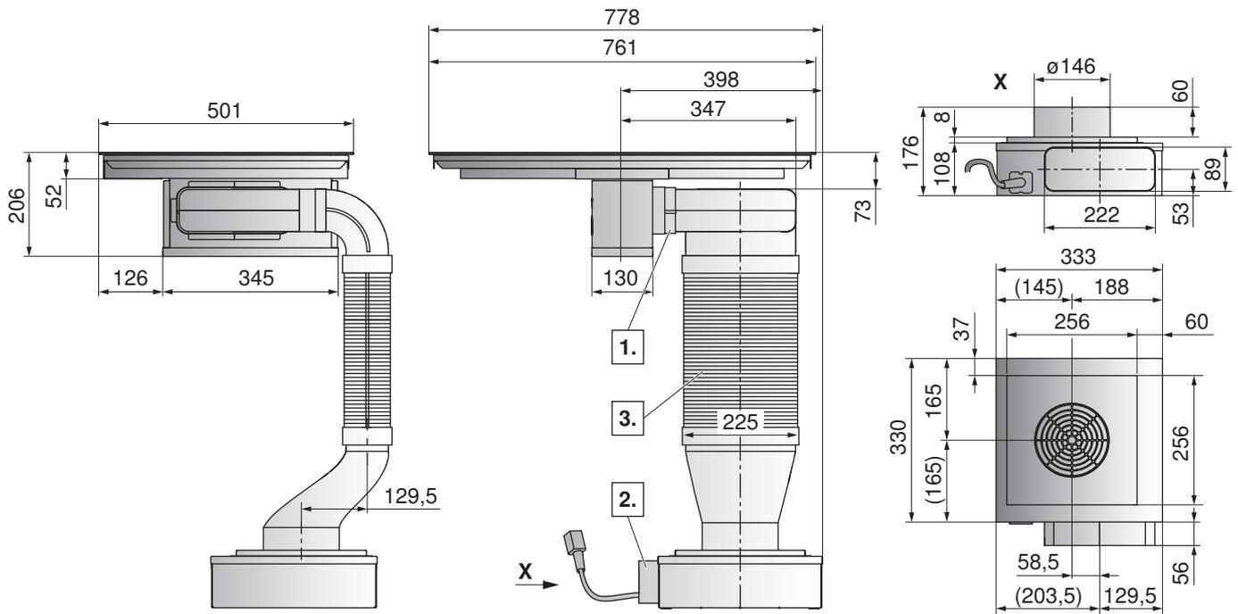
1. Die Abluftführung ist nach links oder rechts möglich.
