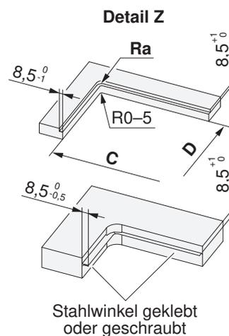
Stahlwinkel geklebt oder geschraubt
