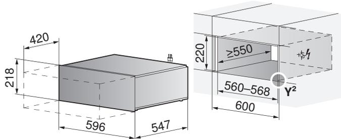
**Einbau mit Kleinbackofen oder Steamer**
