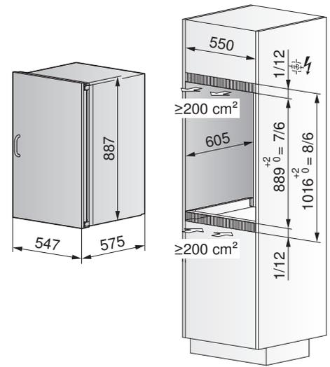
Für Netzsteckeranschluss muss Rückwand am Schrank entfernt werden können.
