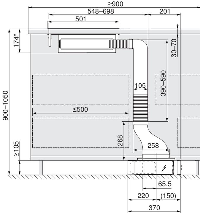
Variante Lüftermotor gedreht
