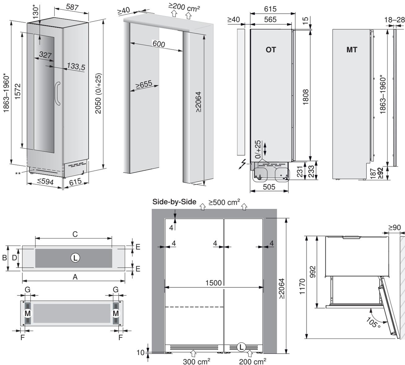
\* = Bei Nischenhöhe >2064 muss Anordnung der Bohrungen am Türdoppel und die Türdoppelhöhe angepasst werden (siehe Installationsanleitung).
