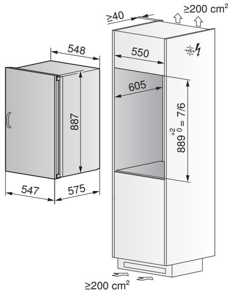
**Einbauvariante mit Lüftungsgitter**
