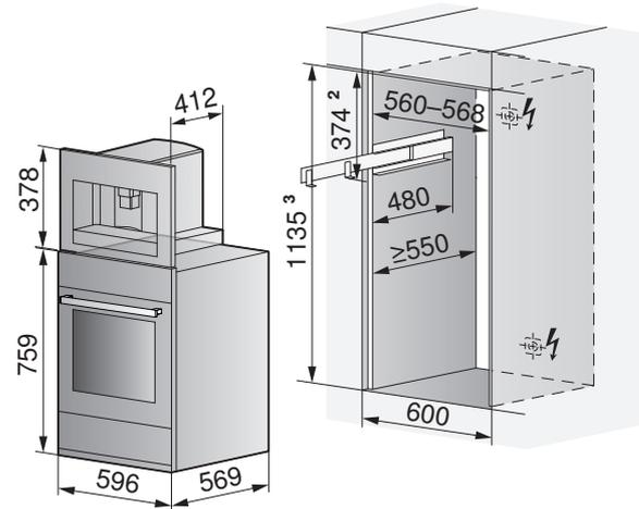
Einbau SMS: <sup>3</sup> Nischenhöhe 1143 mm/<sup>2</sup> Höhe 381 mm
