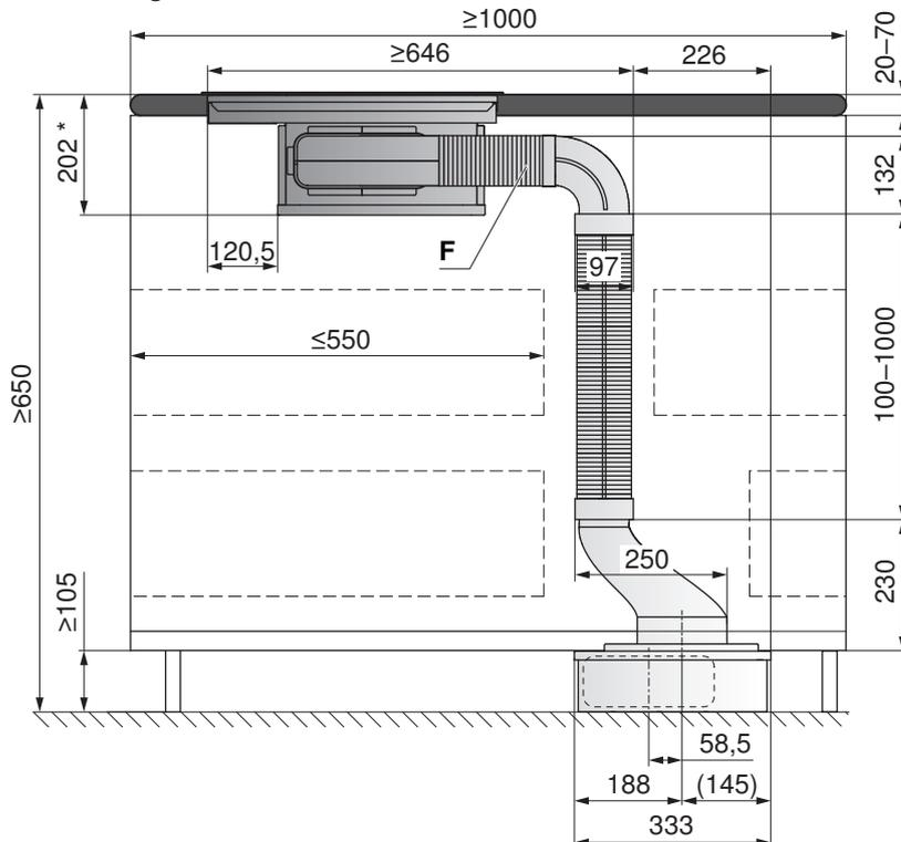
**Variante Lüftermotor gedreht**
