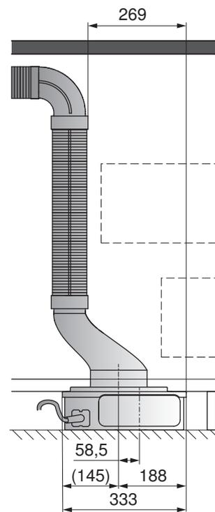
\* aufliegender Einbau (flächenbündiger Einbau 206 mm)
