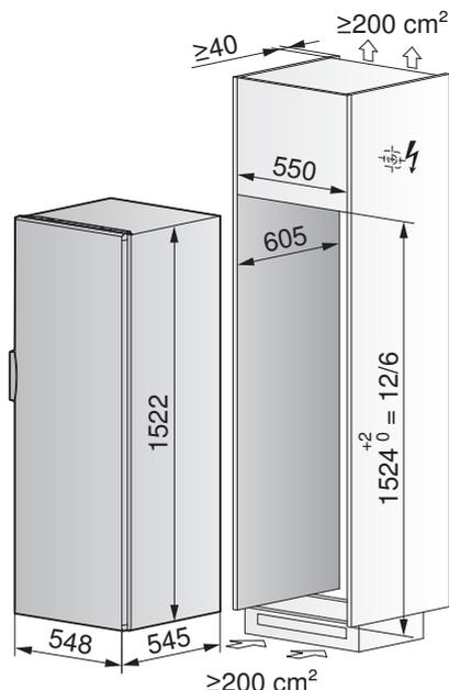
**Einbauvariante mit Lüftungsgitter**
