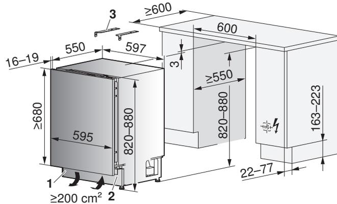
1 Belüftungsteil im Sockel integriert, 2 Sockelrücksprung für die Belüftung dringend einhalten, 3 Montagekit Steinabdeckung (im Lieferumfang enthalten).
