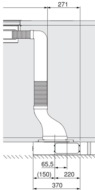
\* Flächenbündiger Einbau. Aufliegender Einbau: 170 mm.
