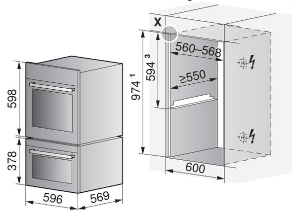
Einbau SMS: <sup>1</sup> Nischenhöhe 981 mm, bei Nischenhöhe 1016 mm: Ausgleichselemente, siehe Kapitel Zubehör (siehe Seite 225)/<sup>3</sup> Höhe 600 mm
